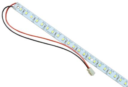
Barreau de LEDs de remplacement avec fils et connecteur adaptés.
